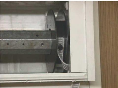
12 Gurt in Mitnahmezapfen einhängen und mittels 12 Wellenumdrehungen aufrollen
